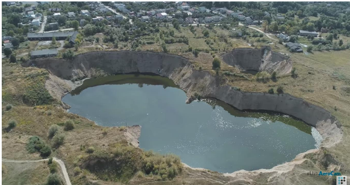
4.17. ábra: A sóbányászat, majd az azt követő vízbetörések miatt kialakult antropogén sókarsztok
